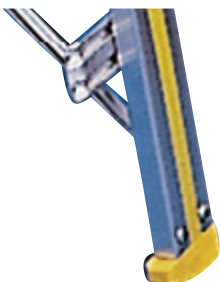
Auswechselbare Leiterfüße (DBGM) mit integriertem Sicherheitsabstand gegen Fingerklemmen
